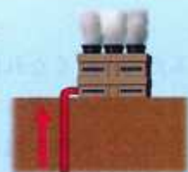
地熱発電 地下の熱水や蒸気を利用して発電機をまわす。
