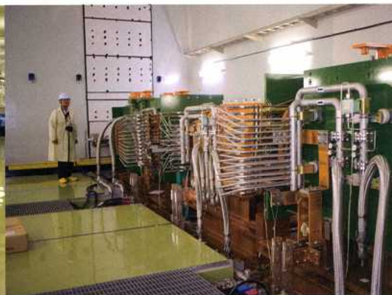
衝突直前 緑色の電磁石の中心軸を少しだけ下に傾け、下向きに陽子を発射する。穴の開いた壁の向こうにターゲットがある(78ページの写真の③)。
