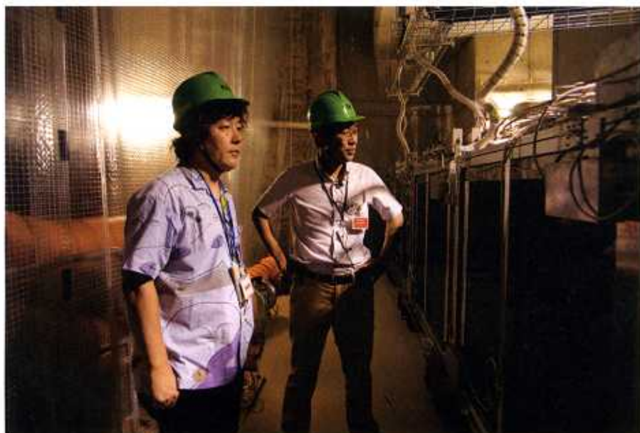
最深部の測定器 右の写真に写った巨大なニュートリノ検出器のさらに下にある検出器。全体は見えないが、膨大な数のシンチレーター（右側の黒い箱）が並んでいる。
