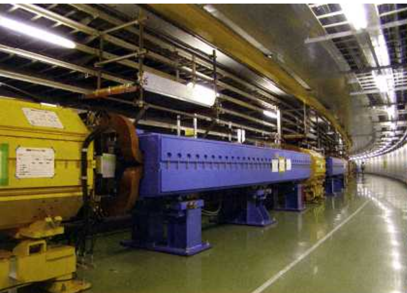
メインリング 全長約1.6kmの円形のトンネルに電磁石が並ぶ。この中で陽子が周回し、ほぼ光速と同じ速さに加速される(78ページの写真の⑤)。
