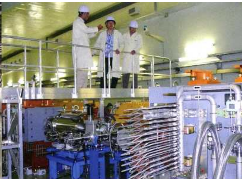
ビームの分岐点 メインリングを飛んできた陽子を、ニュートリノ実験に行くものとメインリングに戻るもの、捨てるものとに分ける場所。
