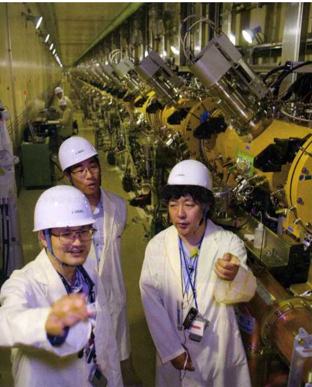
一直線に加速する 加速の第一段階は、負の水素イオンを直線的に飛ばしながら、電場によって加速する線形加速器が担う。負水素は黄色いタンクの中を走り抜け、光速の約55%のスピードに達する。
