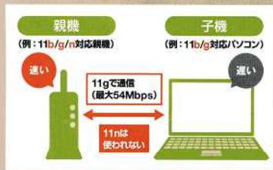
図2 無線LAN規格は大きく、2.4GHz帯を使う「11b」「11g」「11n」と、5GHz帯を使う「11a」「11n」の2種類に分類できる。新しいほど高速。異なる周波数帯の規格同士は通信できない点に注意しよう。
