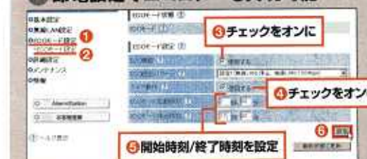
図28 親機によっては、節電設定も可能(1~5)。ここでは、就寝から出勤している間は無線LANを停止するように設定した。
