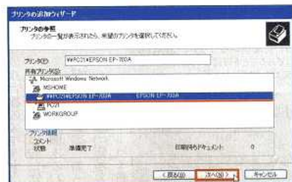
図7 ネットワーク上にある接続可能な「共有プリンター」が一覧表示される。ここでは「EPSON EP-703A」を選んで「次へ」をクリックする
