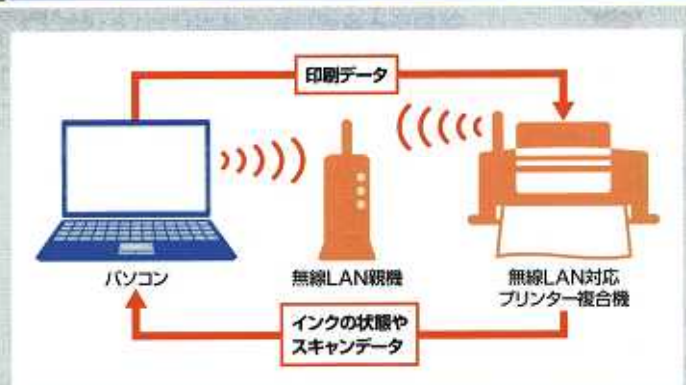
図1 無線LAN対応のプリンターはUSB接続のときと同じように、インクの状態はチェックできるし、複合機であればスキャナーとして使える
