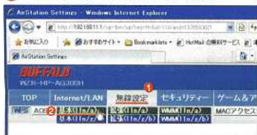
図10 ログインしたら、まずは5GHz帯の無線LANから設定しよう。ページ上部のメニューから「無線設定」→「基本(11n/a)」と選んで①②、設定画面を開く
