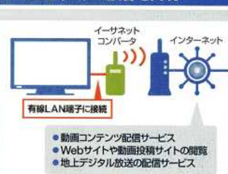
図17 デジタルテレビの有線LAN端子にイーサネットコンバータをつなげば、無線LAN環境につながる。最近では無線LAN機能搭載テレビも登場している
