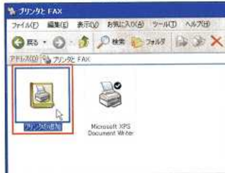
図5 共有設定したプリンターをXPパソコンから利用するには、「プリンターとFAX」で「プリンターの追加」をダブルクリックする
