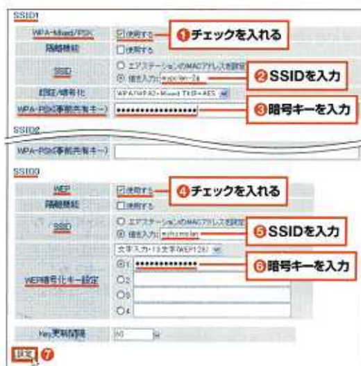
図14 「SSID1」で「WPA-Mixed/PSK」の「使用する」にチェックを入れ(1)、SSIDと暗号キーを入力(2)(3)。同じ手順で「SSID3」の必要な項目に情報を入力する(4)~(7) [注5]
