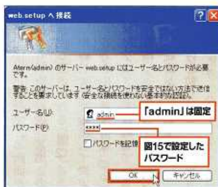
図15 NECアクセステクニカの無線LAN親機でも、図7のようにLANケーブルで接続。ウェブブラウザで親機を呼び出し(1)、管理者用のパスワードを設定する(2)(3)
