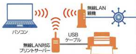
図1 無線LAN非対応のプリンターはプリントサーバーにUSBで接続すればネットワークに接続できる。プリントサーバーが無線LAN対応なら、置き場所も自由になる
