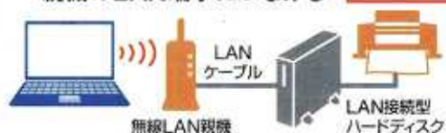
図1 HDDを共有する方法は2つある。親機にHDDをUSBでつなぐかLAN接続型HDDを親機のLAN端子に接続する
