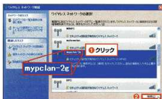
図3 周辺で接続可能な無線LANがすべて表示される。この中から、自分で親機に設定したSSIDのうち接続したいものをクリックして指定し(1)、「接続」ボタンを押す(2)
