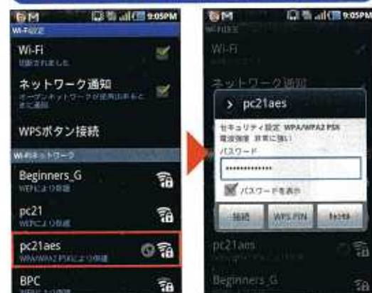
図10 Android端末では、「設定」→「無線とネットワーク」→「Wi-Fi設定」と進んで、SSIDを選び、暗号キー(パスワード)を入力すればOK
