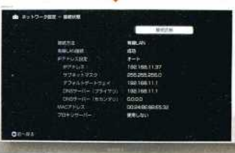
図19 LAN端子とイーサネットコンバータをケーブルで結べば、無線LAN環境が出来上がる。設定画面を見ると、IPアドレスが割り当てられていることが分かる
