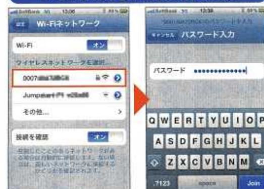
図11 iPhoneも「設定」→「Wi-Fiネットワーク」と進んで「Wi-Fi」をオンにするとSSIDが表示されるので、選んで暗号キー(パスワード)を入力
