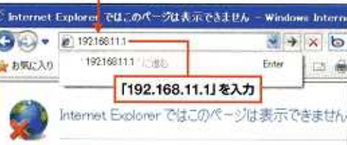
図8 接続したら、親機に張ってあるシールやマニュアルなどでIPアドレスを確認し、ウェブブラウザに入力。これで設定画面を呼び出せる
