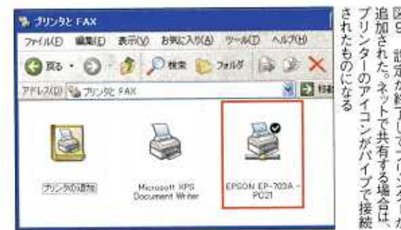
図8 プリンターが接続してあるパソコンにインストールしたプリンタードライバを転送する。ここでは「OK」を押す
