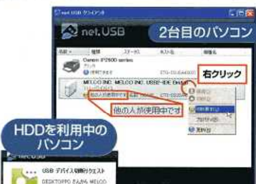
図5 複数のパソコンで1台の周辺機器を同時に使えない。使用中のパソコンに対して「切断要求」を送り(上図)、切断してもらう(左図)
