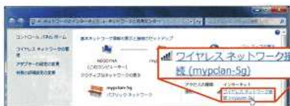
図18 「ネットワークと共有センター」では、「アクティブなネットワークの表示」にある「ワイヤレスネットワーク」をクリックすると「図」接続状態を表示できる(下図)
