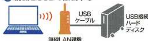
図1 HDDを共有する方法は2つある。親機にHDDをUSBでつなぐかLAN接続型HDDを親機のLAN端子に接続する
