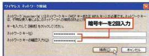
図4 暗号キーの入力画面が現れる。親機に設定した暗号キーを、正確に入力しよう。XPでは、暗号キーを2回入力する。ここでいう「ネットワークキー」が暗号キーのこと
