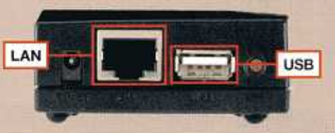
図3 USB端子とLAN端子を1つ備える。接続できるプリンターは1台。有線LANは100BASE-TXに対応
