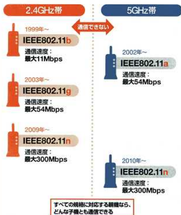
図2 無線LAN規格は大きく、2.4GHz帯を使う「11b」「11g」「11n」と、5GHz帯を使う「11a」「11n」の2種類に分類できる。新しいほど高速。異なる周波数帯の規格同士は通信できない点に注意しよう。
