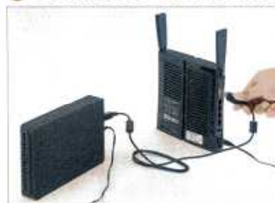
図3 WZR-HP-AG300Hの場合、HDDの無線化は簡単。外付けHDDを、親機のUSB端子にケーブルで接続するだけだ
