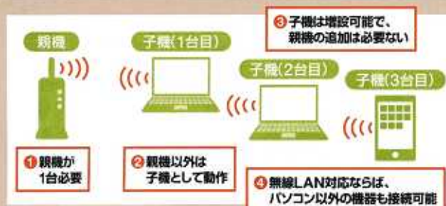
図7 無線LANを利用するには、親機が1台必要。パソコンなどは子機として動作する。子機は増設可能で、その際、親機を増やす必要はない
