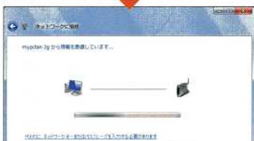
図6 接続可能な無線LANが一覧で表示されるので、接続先のSSIDをクリックして指定し(1)、「接続」ボタンを押す(2)。親機とパソコンが通信している間、数秒待つ
