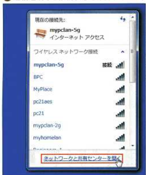
図17 ちゃんと最大通信速度で接続しているかどうか、確認することもできる。タスクトレイのアイコンをクリックし、現れた画面のネットワークと共有センターを選ぶ
