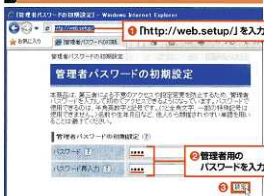
図15 NECアクセステクニカの無線LAN親機でも、図7のようにLANケーブルで接続。ウェブブラウザで親機を呼び出し(1)、管理者用のパスワードを設定する(2)(3)
