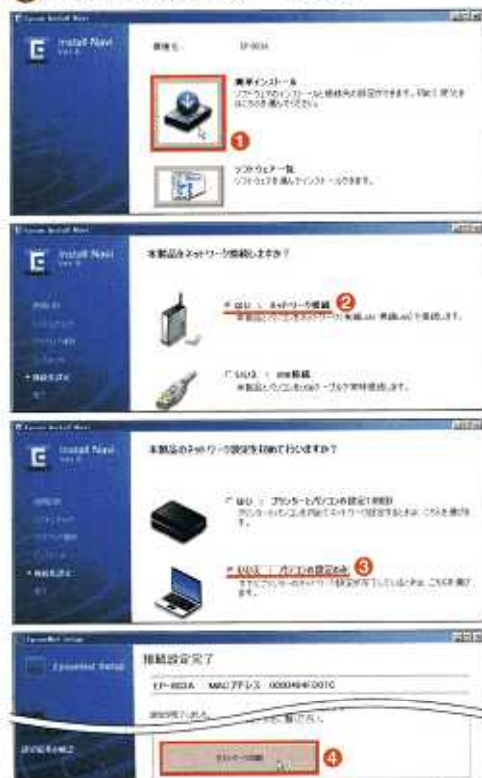
図5 パソコンとプリンターの接続は、プリンター付属のCDから設定ソフトを起動するだけ。「簡易インストール」でドライバーなどを導入して(1)、「ネットワーク接続」→「パソコンの設定」(2)(3)と進む。確認のため「テストページ印刷」を実行しよう(4)
