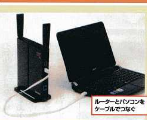
図7 無線LANの設定が終わるまでは、パソコンと親機はLANケーブルで接続するほうが確実。親機に付属のケーブルを使えばよい
