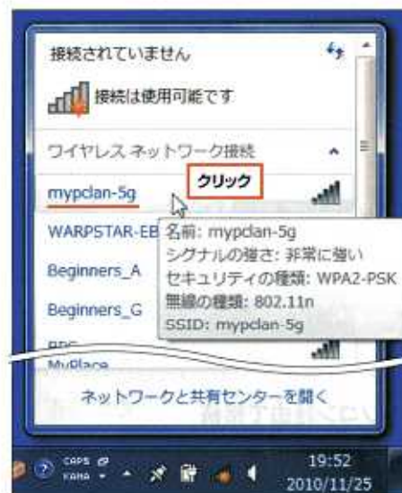
図13 接続可能な無線LANが一覧表示される。接続先のSSIDをクリックして指定する。マウスポインターを合わせると、どの規格で動いているかなどの状態を表示できる
