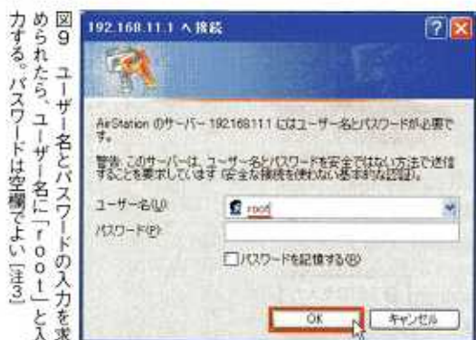
図9 ユーザー名とパスワードの入力を求められたら、ユーザー名に「root」と入力する。パスワードは空欄でよい
