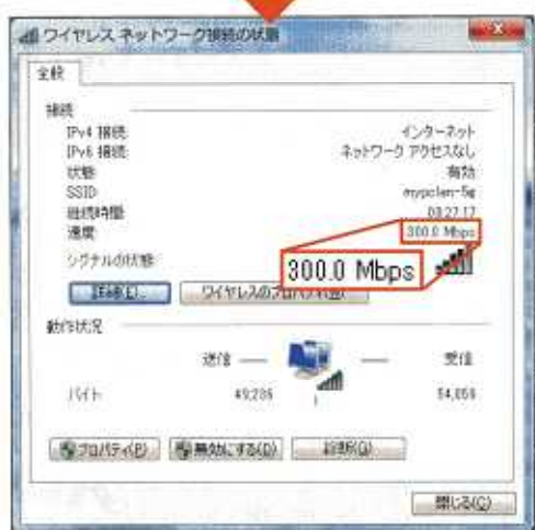
図18 「ネットワークと共有センター」では、「アクティブなネットワークの表示」にある「ワイヤレスネットワーク」をクリックすると「図」接続状態を表示できる(下図)
