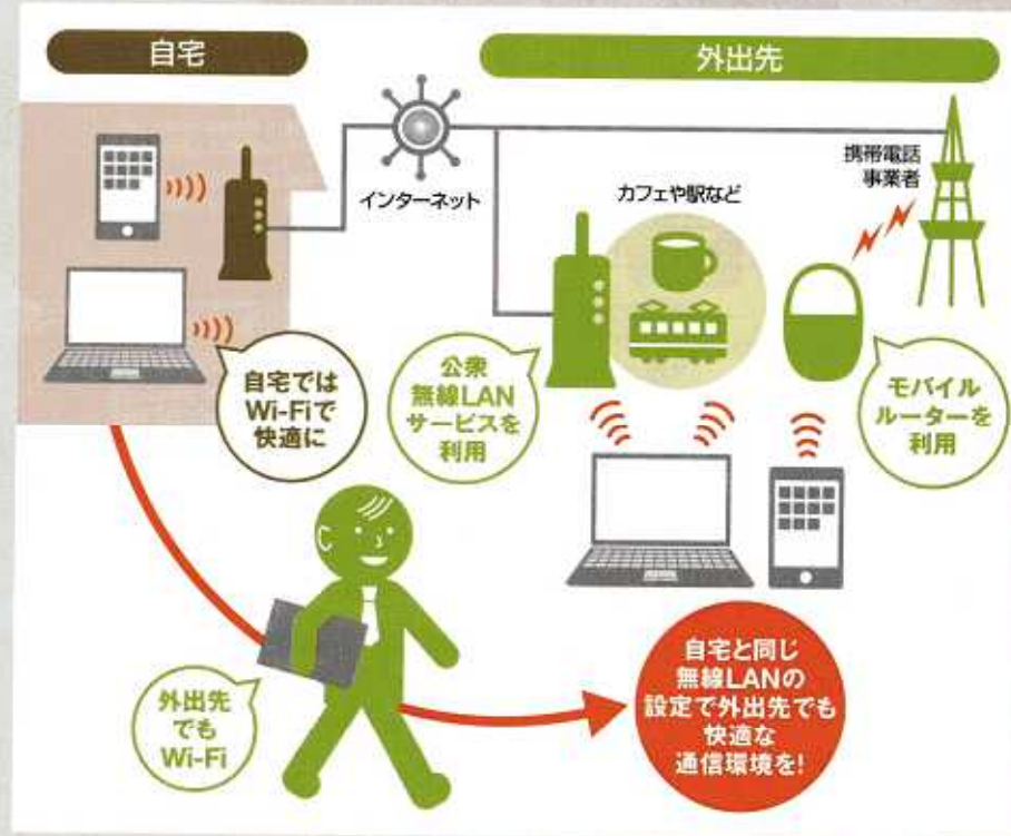
図1 無線LAN (Wi-Fi) の快適な通信環境を外出先にも広げる手段がある。公衆無線LANサービスを使ったり、モバイルルーターを持ち歩いたりすれば、無線LANの使い道が一層広がる
