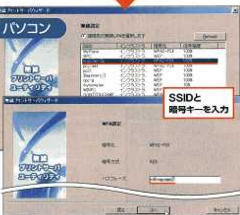
図4 プリントサーバーの準備を整えたら、①、②、パソコン側のセットアップソフトを使ってSSIDと暗号キーをプリントサーバーに記録する。有線LANを外して再度、電源を投入すれば設定終了
