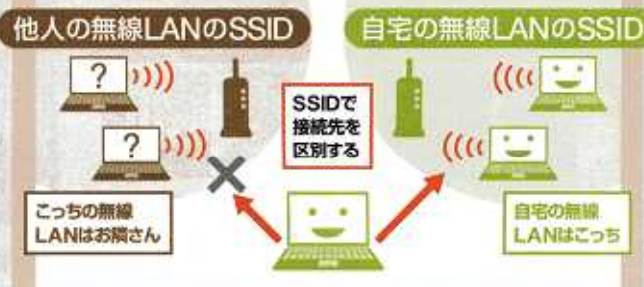
図4 複数の無線LANが稼働している環境で、自分の無線LANを見分けるのが「SSID」だ。他の無線LANと重複しないように設定する。どれだけたくさん無線LANが動いていても、自分で設定したSSIDで、接続先を見分けられる
