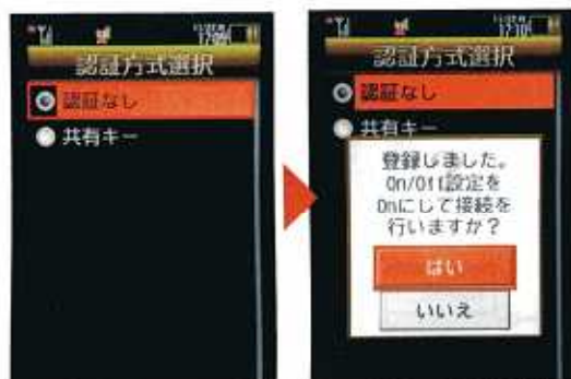
図8 今回はアクセスポイントがWEPだったため認証方式を選択。その後接続するので「はい」を選ぶ
