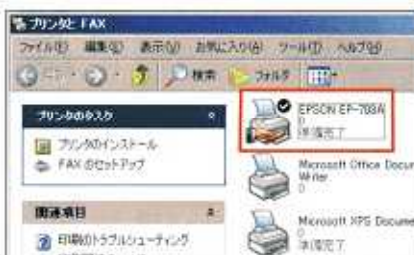
図3 共有するプリンターを選び右クリック(1)。メニューから「共有」を選択する(2)。現れた画面で「このプリンタを共有する」をチェックして(3)、プリンター名を入力し(4)「OK」を押す(5)
