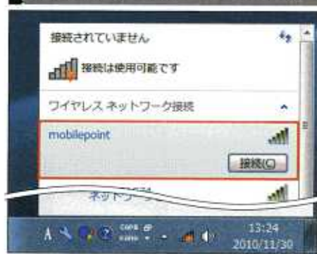
図3 Wi2 3000の例。同サービスで使えるmobilepointを選択し「接続」を押す。FREESPOTならこの手順で接続が完了。Wi2では登録時に連絡された暗号キーを入力する
