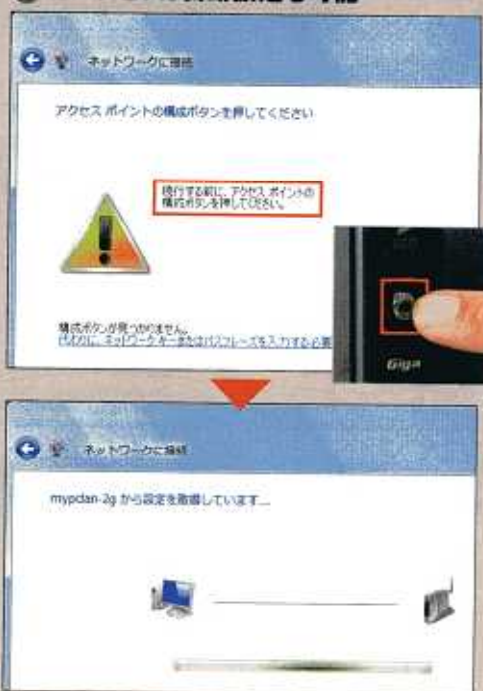
図9 ビスタと7は、標準で無線LANの自動設定機能を備えている。図8の画面で、親機の自動設定ボタンを押すことでも、無線LANに接続できる
