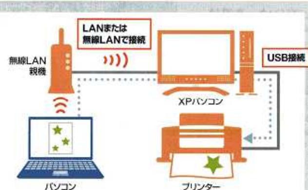
図1 無線LAN非対応のプリンターは、パソコンに接続して共有してみよう。パソコンがネットにつながればプリンターもつながる
